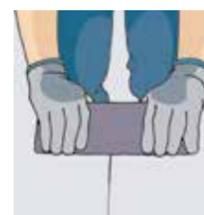
**19.6.** Ao finalizar, pressione as placas com uma régua de madeira revestida com carpete ou rolo compressor de 50kg (exceto para a Linha Paviflex) para que fiquem bem aderidas ao contrapiso.
