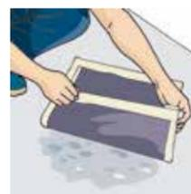
**Método manual** (plástico): coloque pedaços de plástico (mínimo 40x40cm) em diversos pontos do contrapiso. Prenda toda a borda do plástico com fita adesiva e aguarde 24 horas. Se o plástico “transpirar” ou se o contrapiso ficar mais escuro nessa área significa que a água ainda está evaporando e, portanto, o contrapiso está úmido. Deixe o local ventilado e repita o teste alguns dias depois. Este teste não é preciso.
