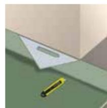
a. Faça um corte de 45° em cada lado da quina utilizando o molde de ângulo 90° e remova o excesso de material. Lembre-se de iniciar a 5mm do chão;
