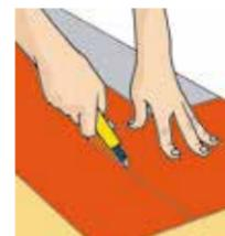
**19.4.** Distribua placas soltas sobre as últimas coladas (próximas às paredes), encoste-as na parede e com um estilete copie os recortes. Dobre a placa para trás e encaixe no espaço correto. Repita este procedimento ao longo de todas as paredes;
