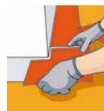
**30.7.** Nas quinas, faça um risco para copiar uma placa / régua e depois mude a placa de lugar, sem mudar sua posição, para copiar a outra parede;
