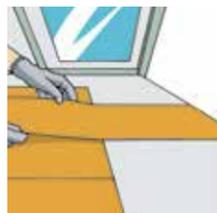
**22.6.** Distribua réguas soltas sobre as últimas coladas (próximas às paredes), encoste-as na parede e com um estilete copie os recortes. Dobre a régua para trás, corte a sobra com o estilete golfinho e encaixe no espaço correto. Repita este procedimento ao longo de todas as paredes;
