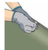
**e.** Depois de instalar as mantas, espalhe o adesivo de duplo contato na área de colagem da parede e por cima do suporte curvo. Aguarde o tack e molde a manta, encaixando a borda na aba do arremate de rodapé com o auxílio de uma chave de fenda.
