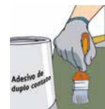
**d.** O adesivo de duplo contato sem toluol deve ser passado no verso da manta antes da sua aplicação, exatamente na área das bordas que serão usadas para a formação do rodapé;
