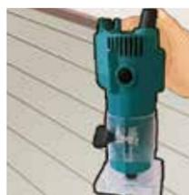
**15.1.1.** Utilize sempre a fresa elétrica para assegurar uma cavidade uniforme e de seção circular. A fresa em paredes deve ser feita com fresador manual tipo "L";
