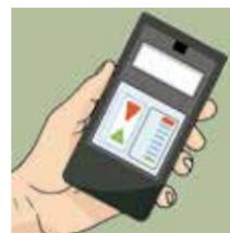
**Método digital:** utilizando um medidor por radiofrequência, coloque o aparelho em uma parte plana do contrapiso ou parede. A interpretação da leitura deve seguir a tabela inscrita no aparelho.
