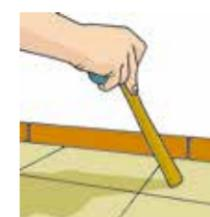
**6.2. Cerâmico:** com juntas inferiores a 5mm. Antes da aplicação da massa de preparação ou autonivelante é necessário o uso de um primer promotor de aderência ou uma demão de adesivo de duplo contato.
