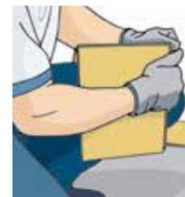
**24.3.** Instale as réguas da primeira fileira, da esquerda para a direita, fazendo um ângulo de 20 a 30 graus ao encaixar a parte do topo. Ao final, meça o espaço faltante e corte uma régua na medida exata para preencher esta área;
