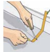
26.1. O aterramento deve ser feito antes da disposição das mantas. Para fixar a fita de cobre, aplique o adesivo condutivo com pincel no contrapiso e sobre a fita de cobre;
