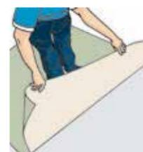
**14.3.** Desdobre a manta para cima do adesivo, trabalhando na direção da parede e respeitando o eixo previamente marcado;
