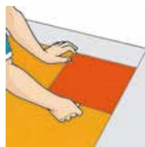
**19.3.** Instale as placas, realizando na sequência os recortes;
