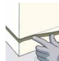
**c.** Utilizando adesivo de duplo contato sem toluol, cole o arremate de rodapé sobre a linha demarcada. Aguarde sua total secagem para iniciar o encaixe da manta;
