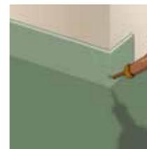
d. Após a secagem do adesivo solde os ângulos de 45°;
