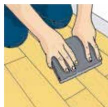
**22.8.** Ao finalizar, pressione as réguas com uma régua de madeira revestida com carpete ou rolo compressor de 50kg para que fiquem bem aderidas ao contrapiso.
