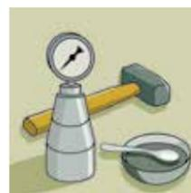
**Método CCM** (carbureto de cálcio), com utilização do aparelho medidor “speed test”, através da retirada de volumes de 3g, 6g ou 12g, a uma profundidade de 2 a 3cm. Para isso, utilize uma marreta e talhadeira. As amostras são colocadas dentro do aparelho de medição, com a esfera de aço e a cápsula de carbureto de cálcio. Ao movimentar o aparelho e romper a cápsula de carbureto de cálcio, dá-se uma reação química e o aparelho mede a quantidade de água presente na amostra.
