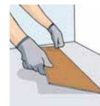
**22.1.1.** Para marcar o eixo, tome como base a parede de início da instalação, conforme paginação. Meça a largura da régua e trace uma linha paralela à parede, no mínimo 1cm menor que essa largura.
