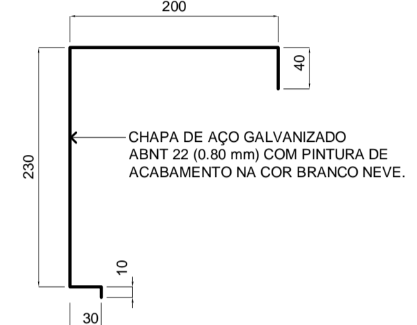
20 RB - CORTE ESCALA: 1/5 MEDIDAS EM mm
