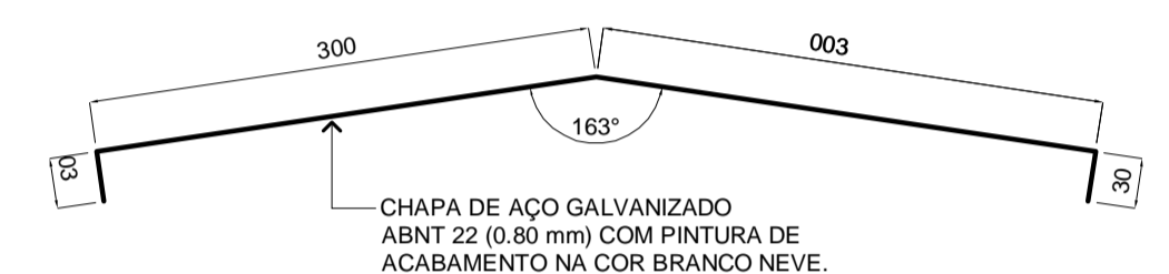
19 CD - CORTE ESCALA: 1/5 MEDIDAS EM mm
